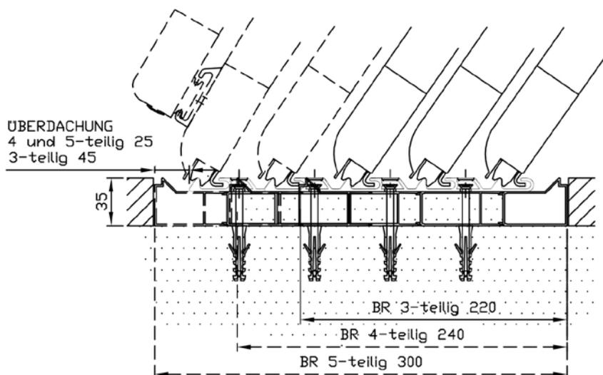
Variante 2: Laufschiene mit Blindrahmen (optional) flächenbündig in die Terrassenfläche versenkt (ein- oder beidseitig)
