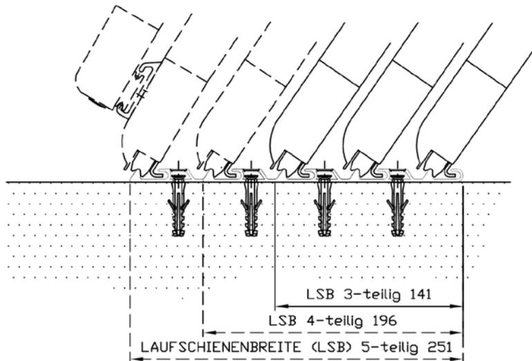
Variante 1: Laufschiene (Höhe 10 mm) auf die Terrassenfläche aufgesetzt (ein- oder beidseitig)
